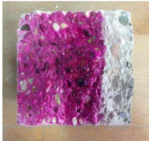
Bild 1.2: Messung an entnommenen Bohrkernen
