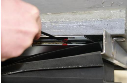
Abbildung 2 - Gleitspaltmessung
